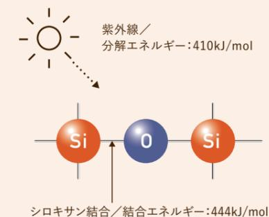
スーパーSDクリアーSi-JYの主成分であるシリコン樹脂はシロキサン結合(Si-O結合)を中心に構成されています。このシロキサン結合はガラスや鉱石など無機物と同じ構造で結合エネルギーが紫外線の分解エネルギーよりも高いため、高い耐候性を発揮します。
