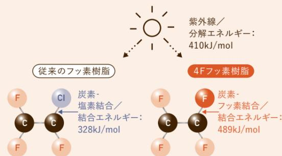
従来のフッ素樹脂はCl(塩素)を多く含み、紫外線に弱く、分離・変質しやすいC-Cl結合が弱点でした。スーパーSDクリアーF-JYはClをF(フッ素)に置き換え、結合力の強いC-F結合とする「4Fフッ素樹脂」を採用。これにより紫外線への耐性を格段に向上させました。
