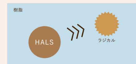
HALSがラジカルを捕捉。ラジカルによる塗膜劣化を抑える。
