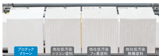
■屋外ばく露雨筋試験/1年経過後比較
