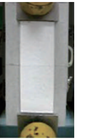
ひび割れ追従試験(ゼロスパンション試験)
