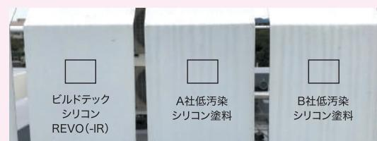
一般低汚染シリコン塗料と比較して雨筋汚れがつきにくく、塗替え後の美しさを保持することが確認されました。
